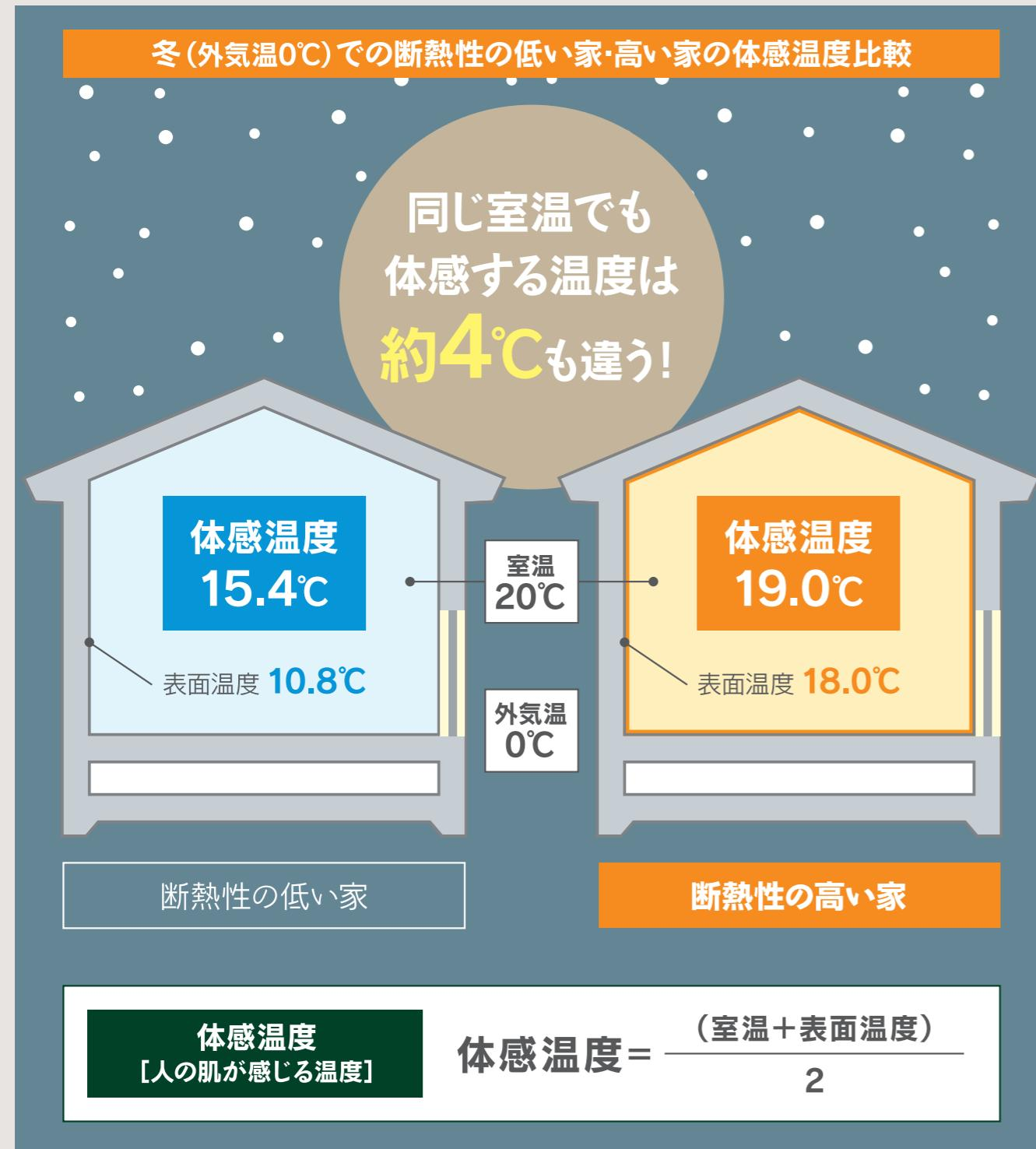
同じ室温でも体感温度の違いにより、断熱性の高い家では心地よいと感じる反面、断熱性の低い家では肌寒く感じるため、快適な温度にするため（体感温度を上げるためにエアコンを強くしたり、設定温度を上げる必要があります）
